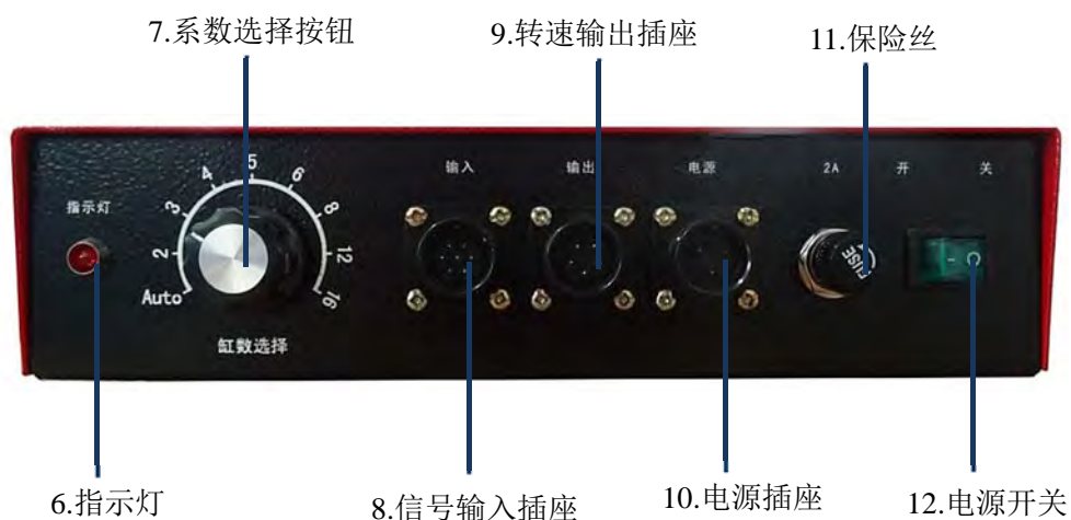
图 1.2 转速表连接图
